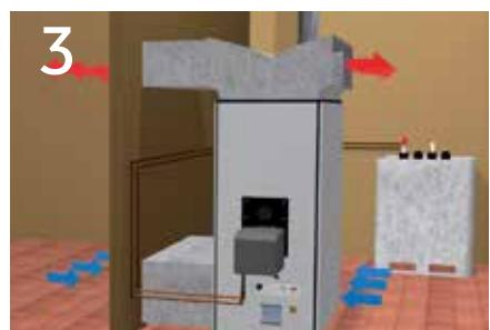
Generador de aire caliente con doble curva para climatizar dos locales adyacentes y aspiración del aire de ambos locales.
