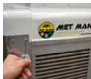
Sistema de apertura rápida con fijadores de media vuelta.
