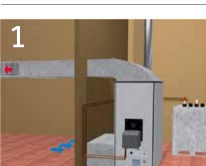
Generador de aire caliente con impulsión de aire mediante red de conductos y aspiración del local adyacente.
