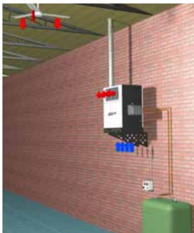
GS-060 con depósito de combustible de doble pared y desestratificador de aire
