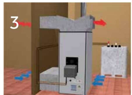
Generador de aire caliente con doble curva para climatizar dos locales adyacentes y aspiración del aire de ambos locales.
