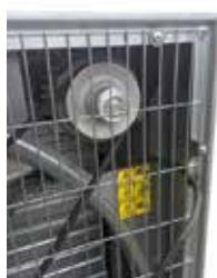
Motor a transmisión con base tensora
