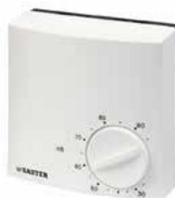
Vigilancia y regulación de la humedad relativa (HR) del aire en locales mediante el control de la ventilación, humidificación y deshumidificación del aire. Dispone de regulador manual con escala 30-90% HR. Grado de protección IP 20. Temperatura de trabajo entre 0°C y 40°C.
